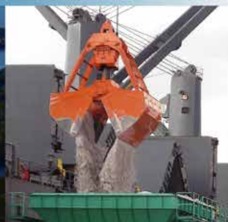
単索無線シリンダー式 グラブバケット 12 m 3 珪砂荷役
